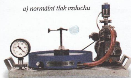
Obr. 2.56 Pokusné ověření existence vztlakové síly ve vzduchu
