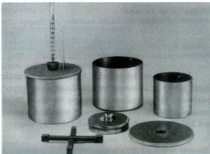
Směšovací kalorimetr (schéma a jednotlivé části)
