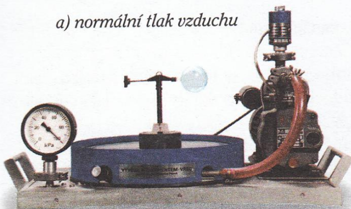
Obr. 2.56 Pokusné ověření existence vztlakové síly ve vzduchu
